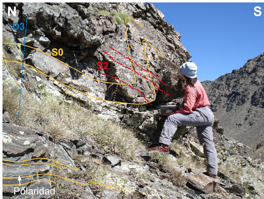
Figura 25. Pliegue de plano axial subhorizontal y foliación asociada (S2) plegados por pliegues de plano axial subvertical (D3).
